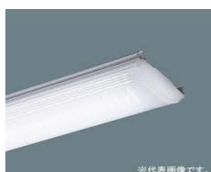
一般型蛍光ランプ FLR40W×2灯 全光束6900lm/消費電力85W=81 lm/W
