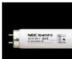
一般型蛍光ランプ FLR40W×2灯 全光束6900lm/消費電力85W=81 lm/W
